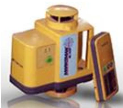
é um instrumento para medição eletrônica e registro automático de distâncias horizontais e verticais ou diferenças de nível, portanto, não mede ângulos
