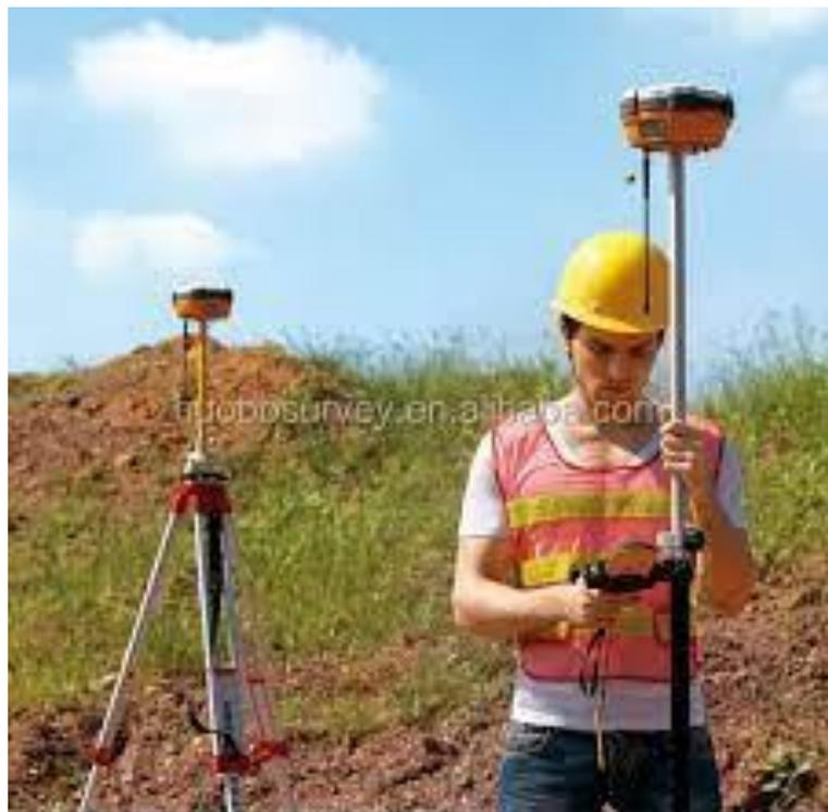
A técnica de posicionamento RTK é baseada na solução da portadora dos sinais transmitidos pelos sistemas globais de navegação por satélites GPS, Glonass e Galileo, este último ainda em fase de implantação. Uma estação de referência provê correções instantâneas para estações móveis, o que faz com que a precisão obtida chegue ao nível centimétrico.
