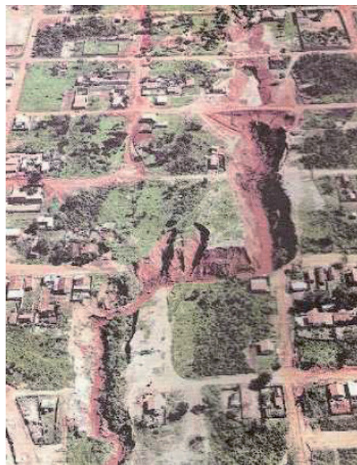
Fig. 7.13 Boçoroca na região urbana do município de Bauru (SP), desenvolvida o momento intempérico em arenitos da bacia do Paraná. Foto de 1993, arquivo IPT-SP
