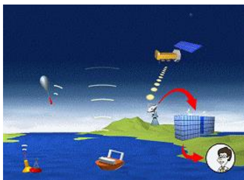
Figura 1: O sistema Argos e seus três segmentos. Fonte: www.cls.fr .
