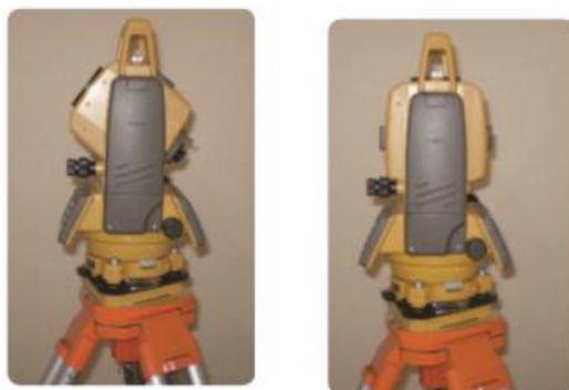
Figura 4: a) Estação total vista de lado sobre tripé, luneta apontada a 45° do horizonte; e b) luneta apontada para o zênite.
