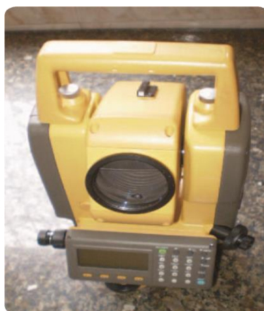
Figura 1: Estação total vista de frente, teclados de comandos e display de visualização.
