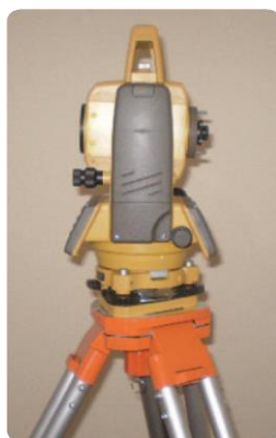
Figura 3: Estação total vista de lado sobre tripé, luneta apontada para o horizonte.
