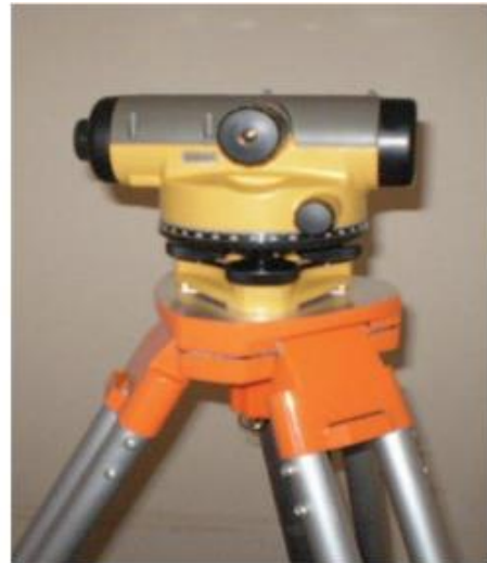
Figura 10: Nível sobre tripé. A luneta do nível é fixa sob o eixo horizontal, ou seja, ela aponta sempre para o horizonte.
