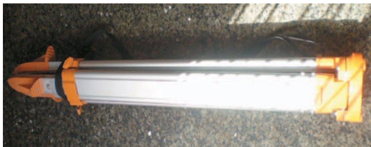
Figura 12: Tripé em alumínio para suporte de estação total e nível.
