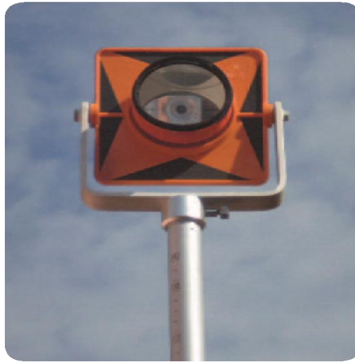
Figura 5: Prisma sobre bastão de 2,70 m de altura.
