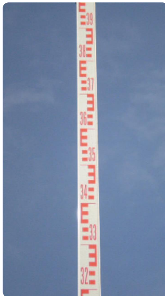
Figura 11: Mira de quatro metros, graduada em metros, decímetros e centímetros.
