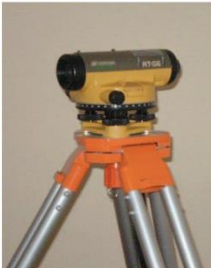
Figura 10: Nível sobre tripé. A luneta do nível é fixa sob o eixo horizontal, ou seja, ela aponta sempre para o horizonte.
