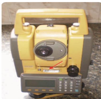
Figura 2: Estação total vista de costa. Repare na seta indicando a posição do nível de bolha.
