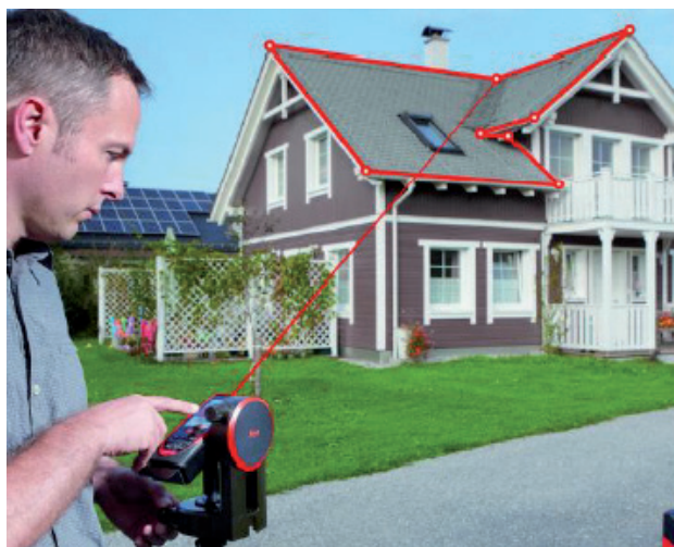
Medição externa com trena a laser com câmera sobre tripé
