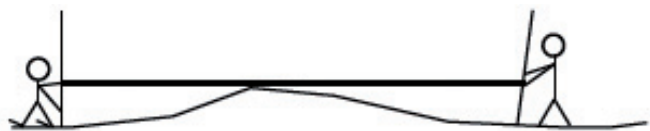
Baliza fora da vertical - ERRADO!
