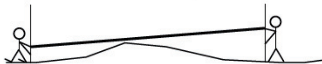
Trena fora da horizontal - ERRADO!
