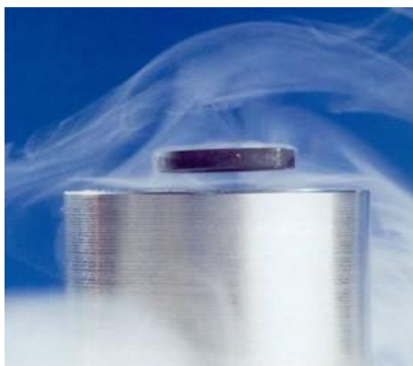
Figura 21: Ímã flutuando sobre a superfície de um material supercondutor.
