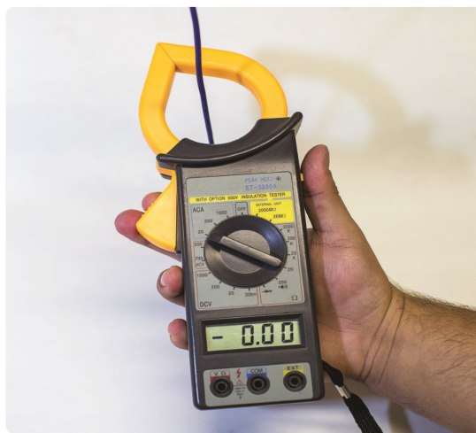
Figura: Medição de corrente com um amperímetro com garra
