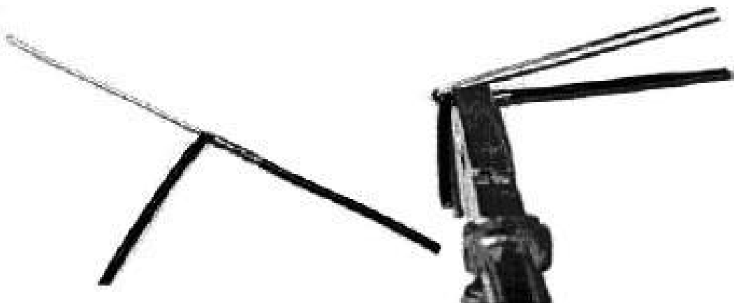
Figura: Cruzamento entre condutores
