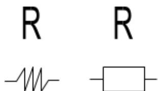
Figura- Símbolos da resistência elétrica
