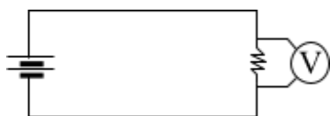
Figura: Medição de um voltímetro
