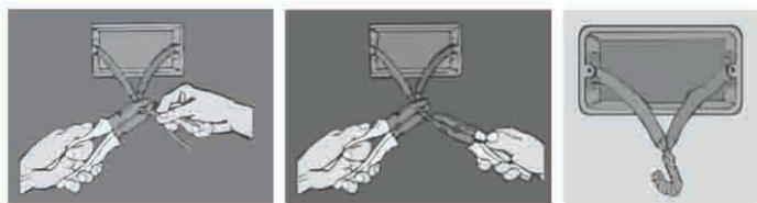
Fig. – Fazendo emendas na caixa de passagem
