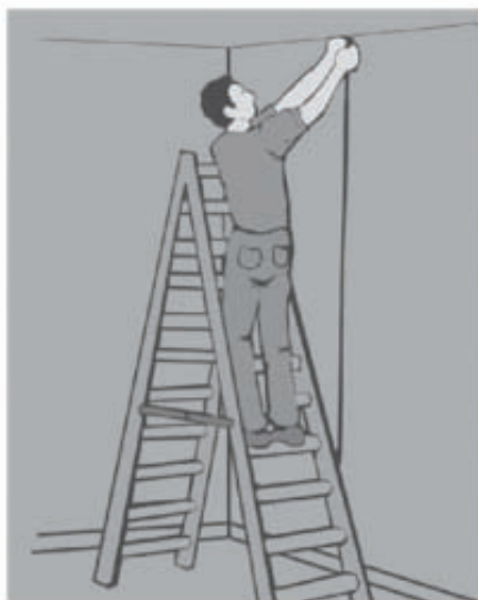
Fig. – Marcando o percurso da instalação na parede
