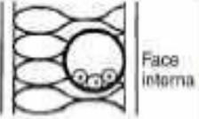
Face interna | Condutores isolados ou cabos unipolares em eletroduto de seção circular embutido em parede termicamente isolante <sup>2)</sup>                            | A1                                 |
