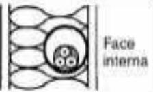
Face interna | Cabo multipolar em eletroduto de seção circular embutido em parede termicamente isolante <sup>2)</sup>                                                    | A2                                 |
