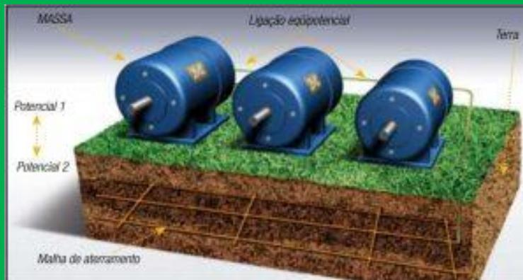
**Figura 31:** Exemplo que ilustra o conceito de equipotencialização: as massas *M* são colocadas no mesmo potencial entre si, mas podem estar em um potencial diferente em relação à terra.
