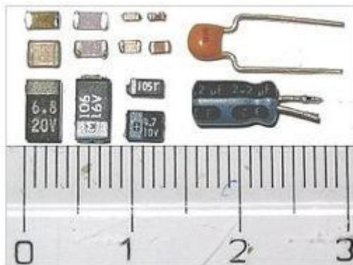
**Figura 13:** Representação de um objeto real (capacitores).
