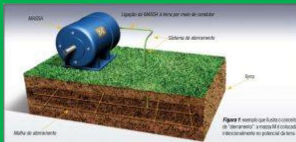
**Figura 30:** Exemplo que ilustra o conceito de aterramento: a massa M é colocada intencionalmente no potencial da terra.
