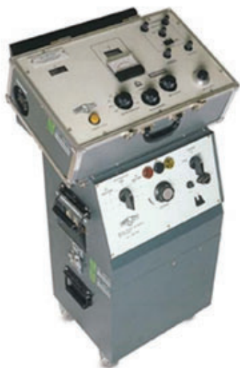
Figura 63: Medidor de Fator de potência – Fator de perdas dielétricas (Nansen)
