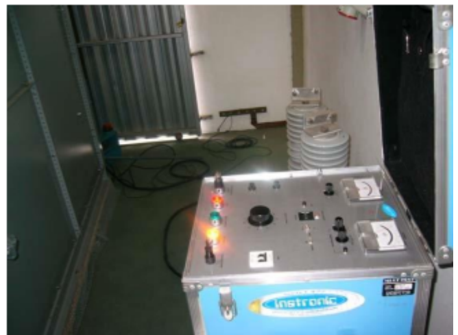
Figura 61: HI-POT 100 KV – Etapa de comando
