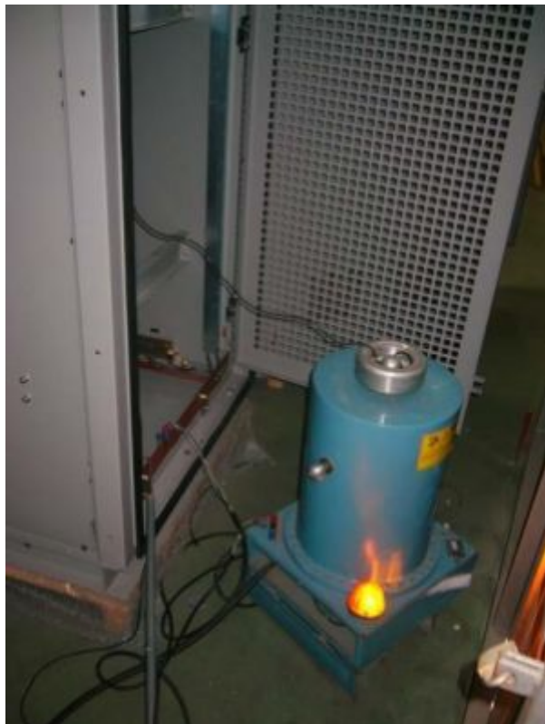
Figura 62: HI-POT 100 KV – Etapa de força.
