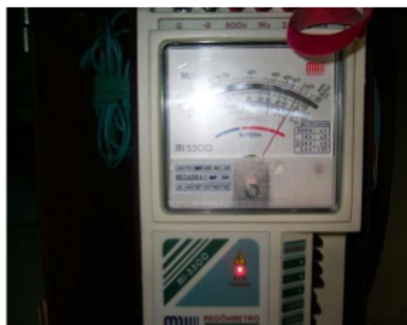
Figura 55: Megôhmetro Eletrônico de Alta Tensão-10kv Figura 56: Megôhmetro Analógico de Alta Tensão - 5kv
