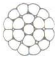
Figura 45: Condutor encordado compactado
