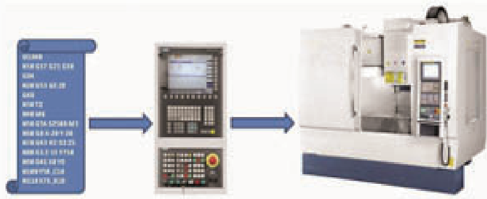
Figura: Componentes básicos de um sistema NC
