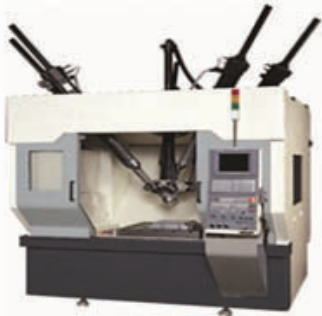
Figura: Centro de usinagem "Hexapod" M-600V, produzido pela empresa Okuma
