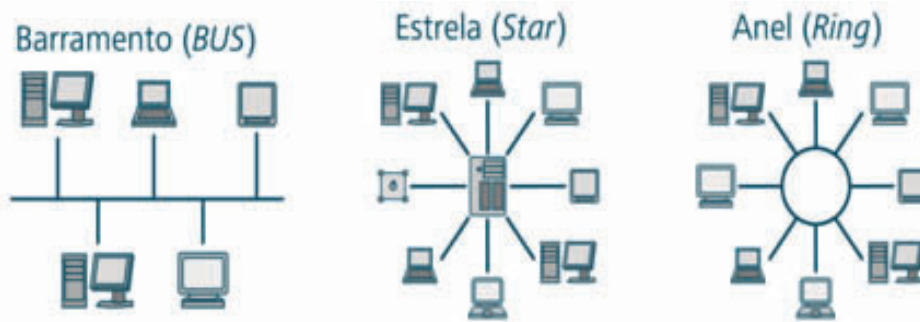
Figura: Redes de difusão: (a) barramento, (b) estrela e (c) anel
