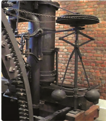
Figura: Regulador de fluxo de vapor de Watt
