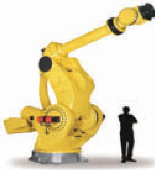
Figura: Robô industrial com capacidade de carga de 1.200 kg e alcance horizontal de 4,6 m Fonte: www.fanucrobotics.com
