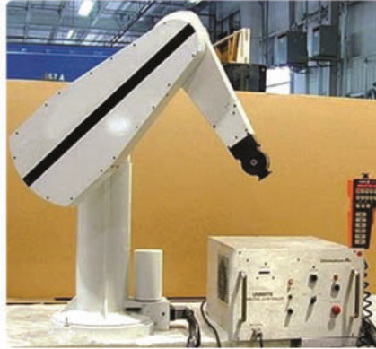
Figura : Robô PUMA com seu controlador
