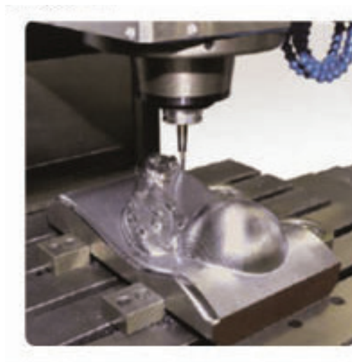
Figura: Usinagem de uma peça em um centro de usinagem vertical
