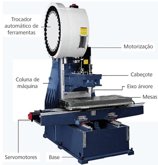
Figura: Estrutura e componentes de um centro de usinagem CNC
