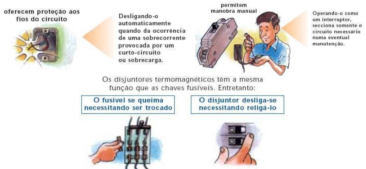
Figura - Características do disjuntor termomagnético
