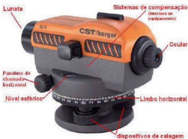
Partes de um Nível óptico automático (Berger, modelo CST)
