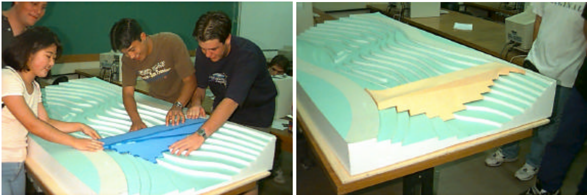
Figura 05 - Testes de encaixe das maquetes das barragens no terreno
