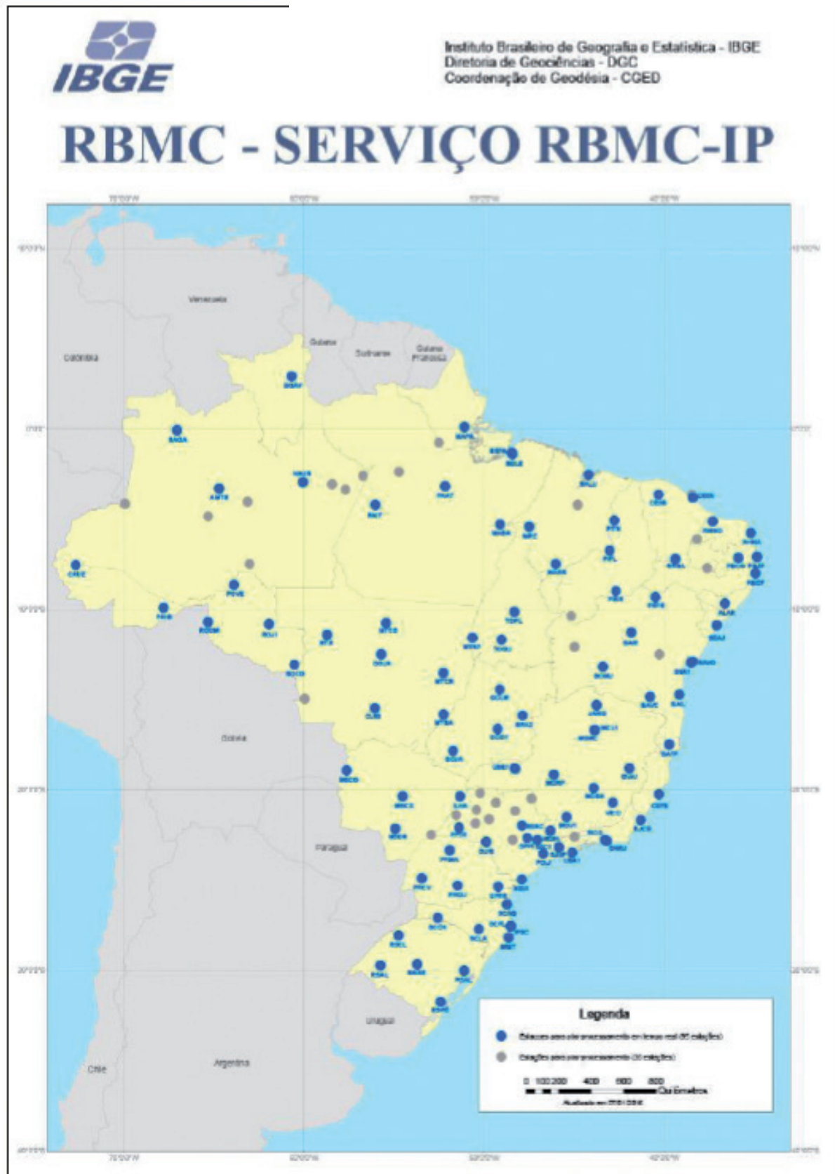
Figura 5.5 – Estações da RBMC que transferem dados em tempo real via NTRIP (serviço RBMC-IP).
