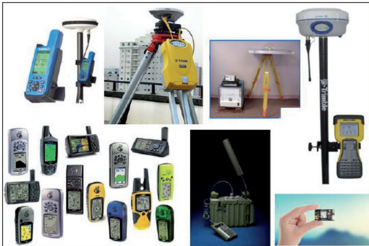
Figura 1.8 – Diferentes tipos de receptores GPS (de navegação, simples frequência, dupla frequência).
