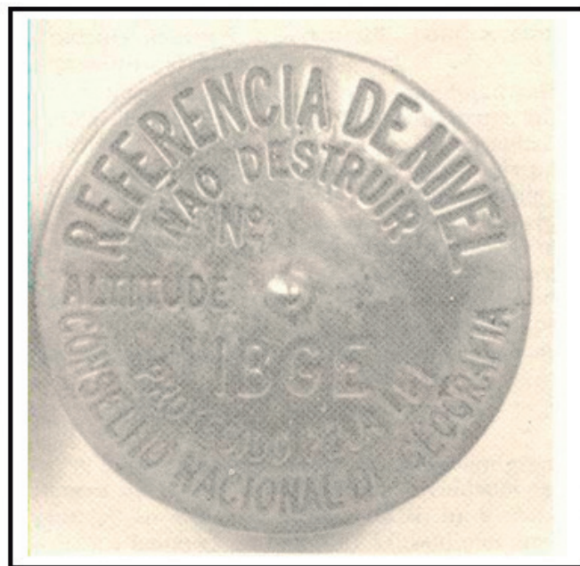
Figura 4.1 Referência de nível do marco geodésico pertencente ao SGB
