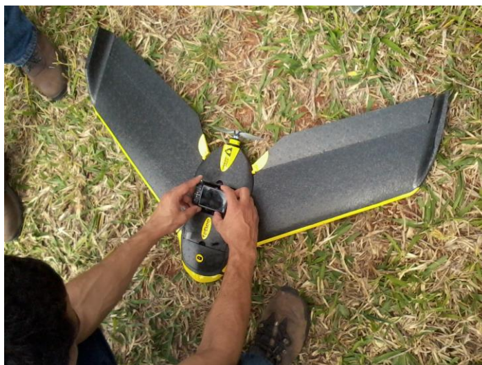
Figura 4 – VANT utilizado no voo (modelo eBee - SenseFly)
