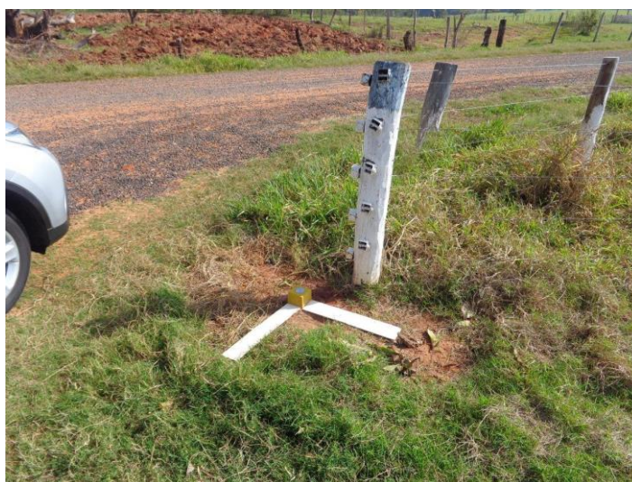
Figura 3 – Marco (M13) implantado e sinalizado
