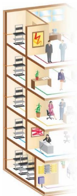
**Figura 9:** Subsistema backbone / rede primária.
