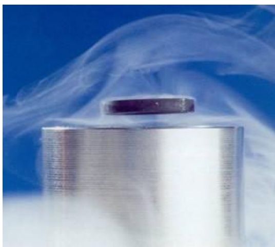
Figura 17: Ímã flutuando sobre a superfície de um material supercondutor.
