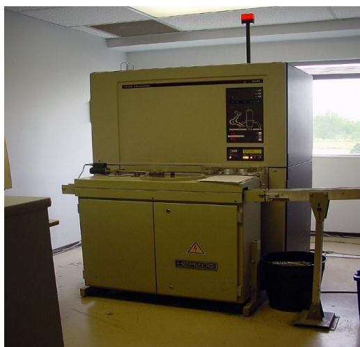
Figura 7: Espectrômetro de fluorescência de raios-X Philips PW1606 com alimentação de amostra automatizada em um laboratório de controle de qualidade de fábrica de cimento.
