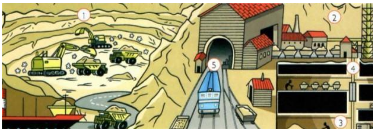
Figura 1: Exploração mineira: pedreira (1), mina (2), galeria (3), elevador (4), trem mineiro (5).
