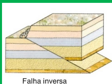
Figura 29: Representação esquemática de uma falha inversa, na qual o bloco superior é deslocado para cima em relação ao bloco inferior devido a esforços compressivos.
