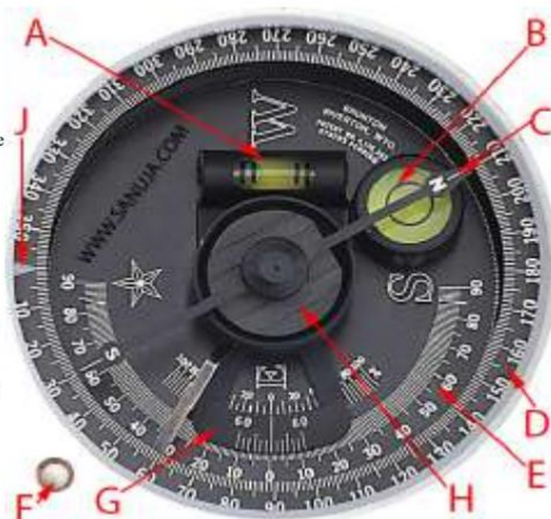
Figura 14: Esquema da bússola geológica.
