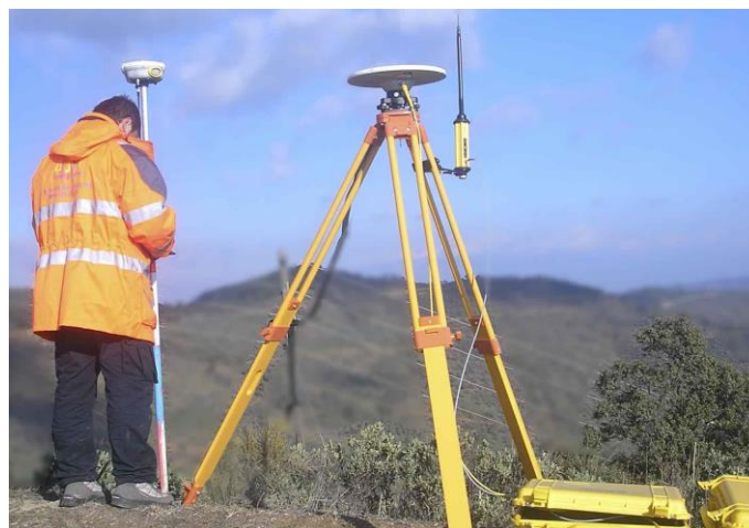
Figura 16: Trabalho de campo utilizando um receptor GPS para coleta de dados geológicos.
