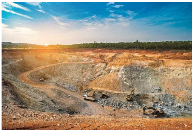
Figura 4: Exemplo da utilização do método de lavra a céu aberto.
