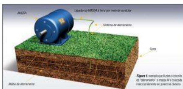
Figura 44: Exemplo que ilustra o conceito de aterramento: a massa M é colocada intencionalmente no potencial da terra.
