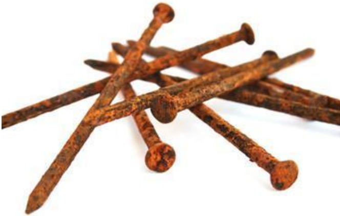
Figura 9: Exemplos de ferrugem (pregos enferrujados).
