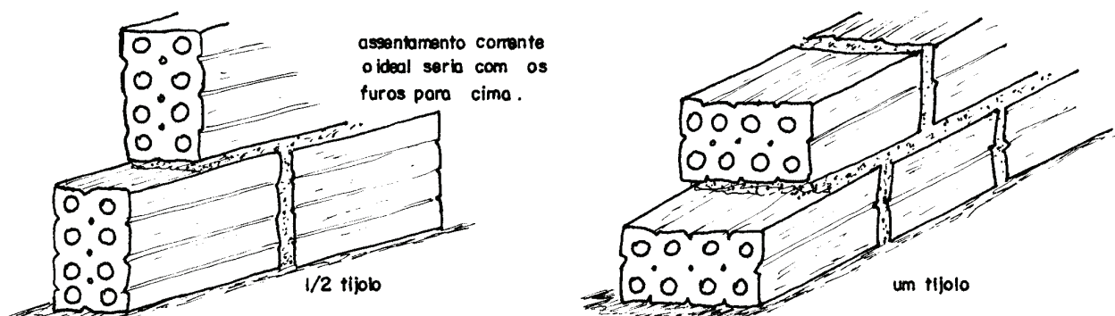
Figura 26 - Execução de alvenaria utilizando tijolos furados
