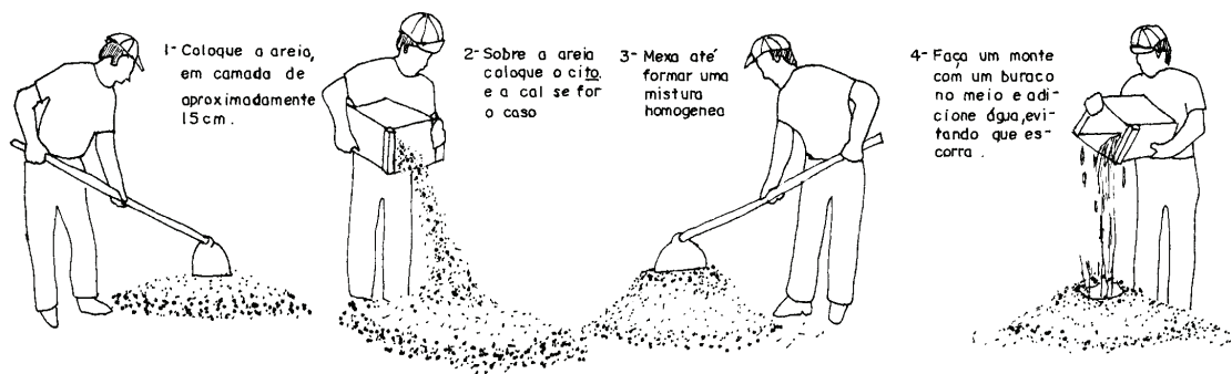
Figura 43 - Preparo da argamassa manualmente
