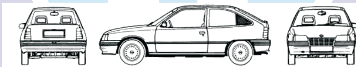
Figura 20 – Representação de um carro no primeiro diedro
