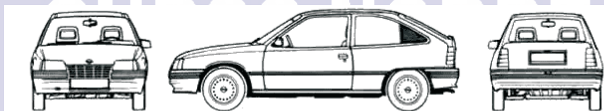
Figura 21 – Representação de um carro no terceiro diedro
