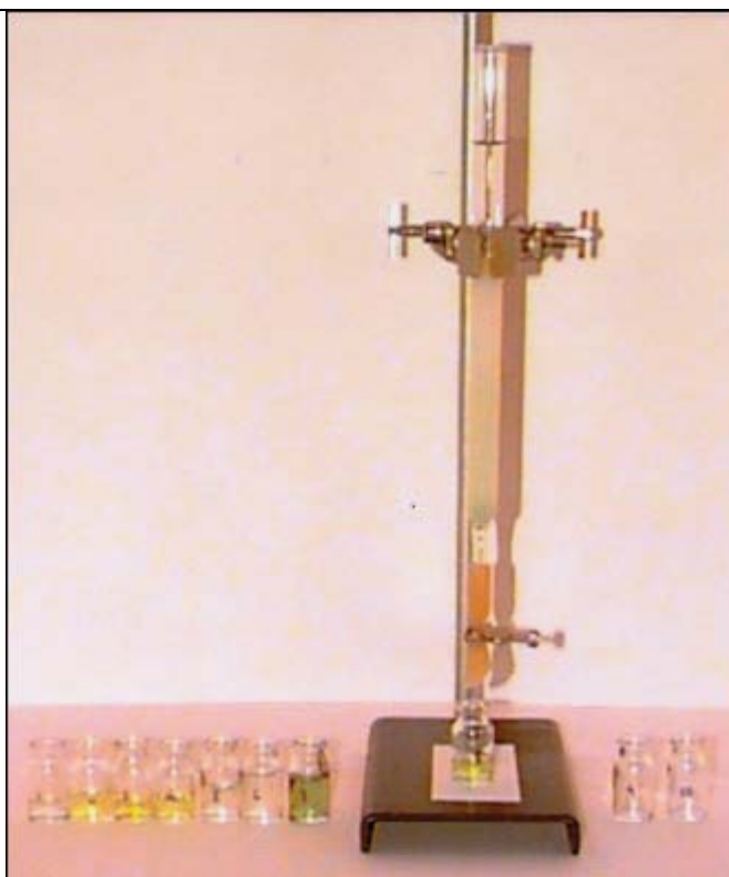
Figura 3: Frações da cromatografia em coluna do extrato de espinafre.
