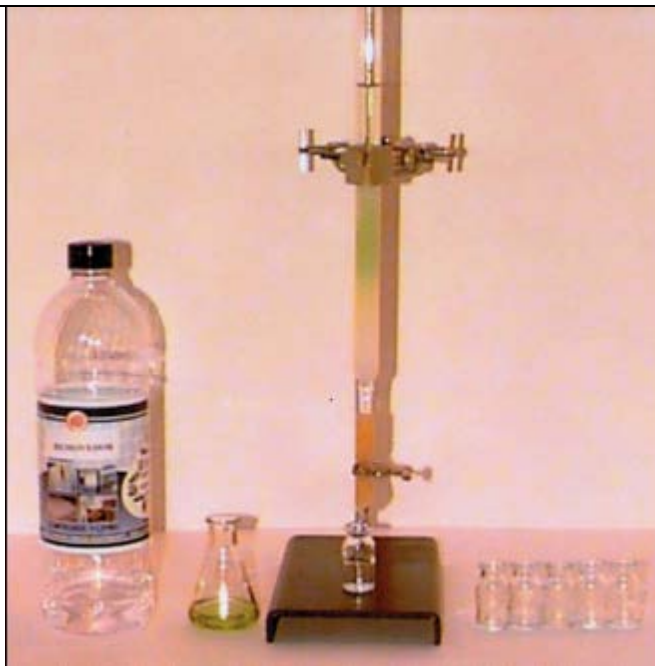
Figura 2: Separação do extrato de espinafre na coluna de açúcar.
