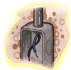
----- Eletroduto embutido na parede
