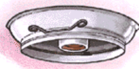
Ponto de luz no teto 100 - potência de iluminação 2 - número do circuito a - comando
