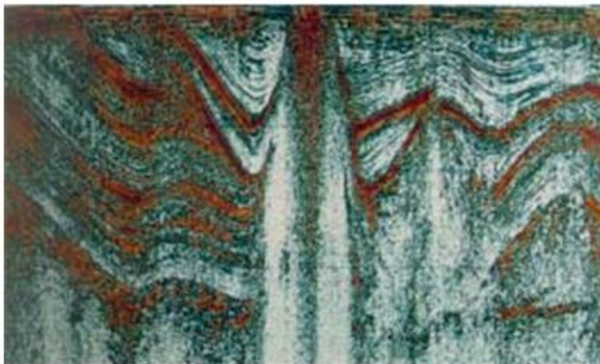
Figura 1.4: Seção sísmica indicando diferentes litologias e possíveis acumulações de gás natural.
