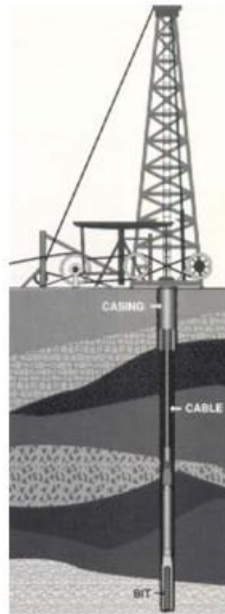
Figura 2.1: Esquema de uma sonda de perfuração a cabo.
