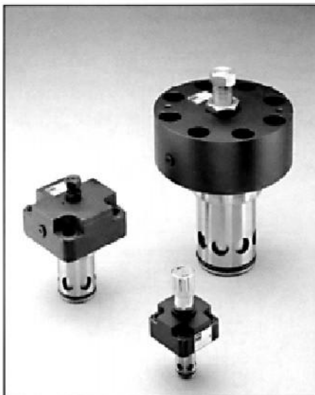
Função de 2 vias, com limitações de curso, pilotagem interna através de "x" Tamanho nominal 25,50 e 100
