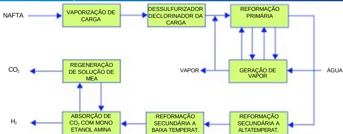
Diagrama esquemático da geração de hidrogênio (Reforma com Vapor).
