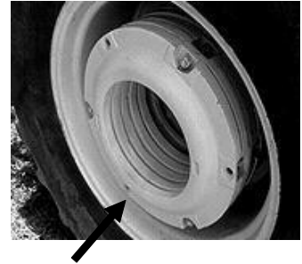
Lastro de ferro fundido frontal na roda traseira
