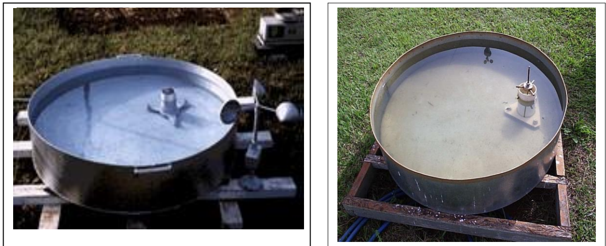
Figuras a e b – Tanque evaporimétrico “Classe A”.
