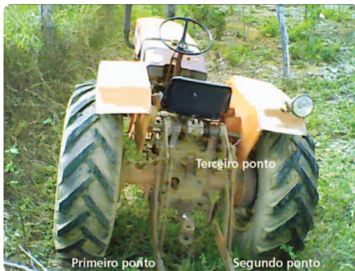
Figura -Localização dos engates: inferior esquerdo (primeiro ponto), inferior direito (segundo ponto) e superior (terceiro ponto)
