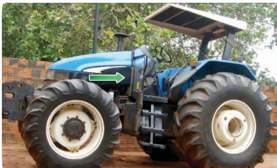
Figura - Localização das alças e estribos nos tratores agrícolas
