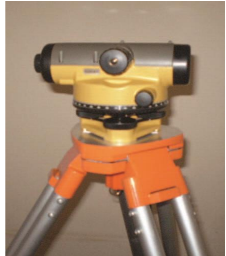
Figura: Nível sobre tripé. A luneta do nível é fixa sob o eixo horizontal, ou seja, ela aponta sempre para o horizonte
