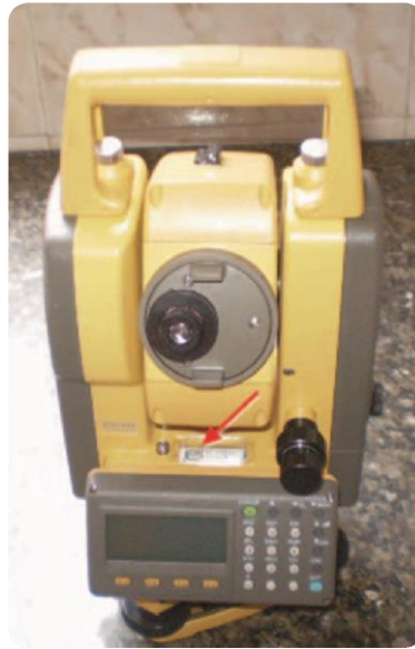
Figura: Estação total vista de costa. Repare na seta indicando a posição do nível de bolha
