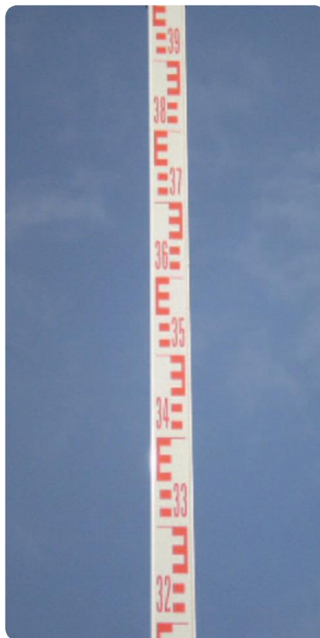
Figura: Mira de quatro metros, graduada em metros, decímetros e centímetros
