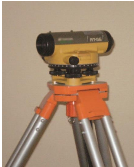
Figura: Nível sobre tripé. A luneta do nível é fixa sob o eixo horizontal, ou seja, ela aponta sempre para o horizonte
