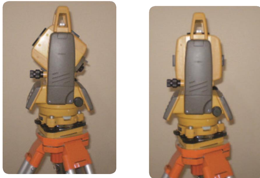
Figura: a) Estação total vista de lado sobre tripé, luneta apontada a 45° do horizonte; e b) luneta apontada para o zênite
