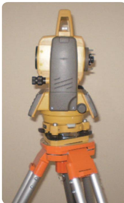
Figura: Estação total vista de lado sobre tripé, luneta apontada para o horizonte.
