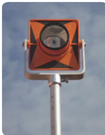
Figura: Prisma sobre bastão de 2,70 m de altura
