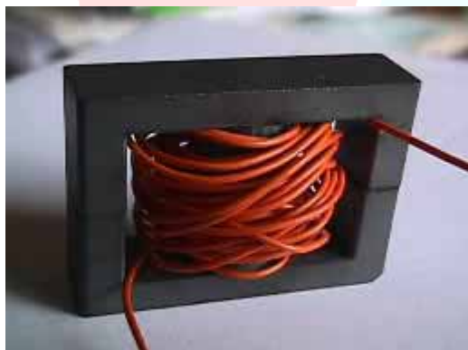
Núcleo de transformador com bobina de enrolamento primário.
