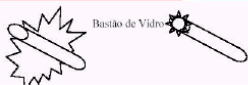
Fig. No bastão de vidro, as cargas em excesso se localizam na região atritada. O vidro é um isolante.
