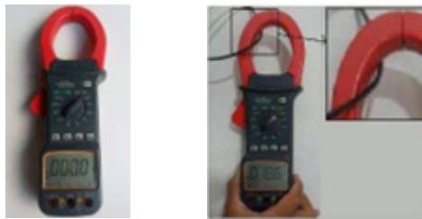
Utilização do Alicate amperímetro
