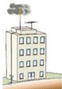
Instalação de Proteção externa
