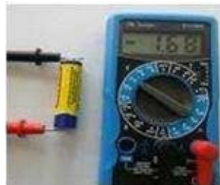
Ponteiras com polaridades invertidas.
