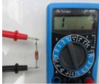
Medida de resistor na escala abaixo do valor da resistência.
