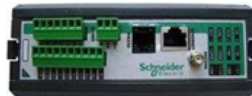
Gerenciador de Energia
