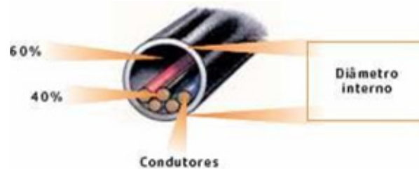
Definição do diâmetro do eletroduto
