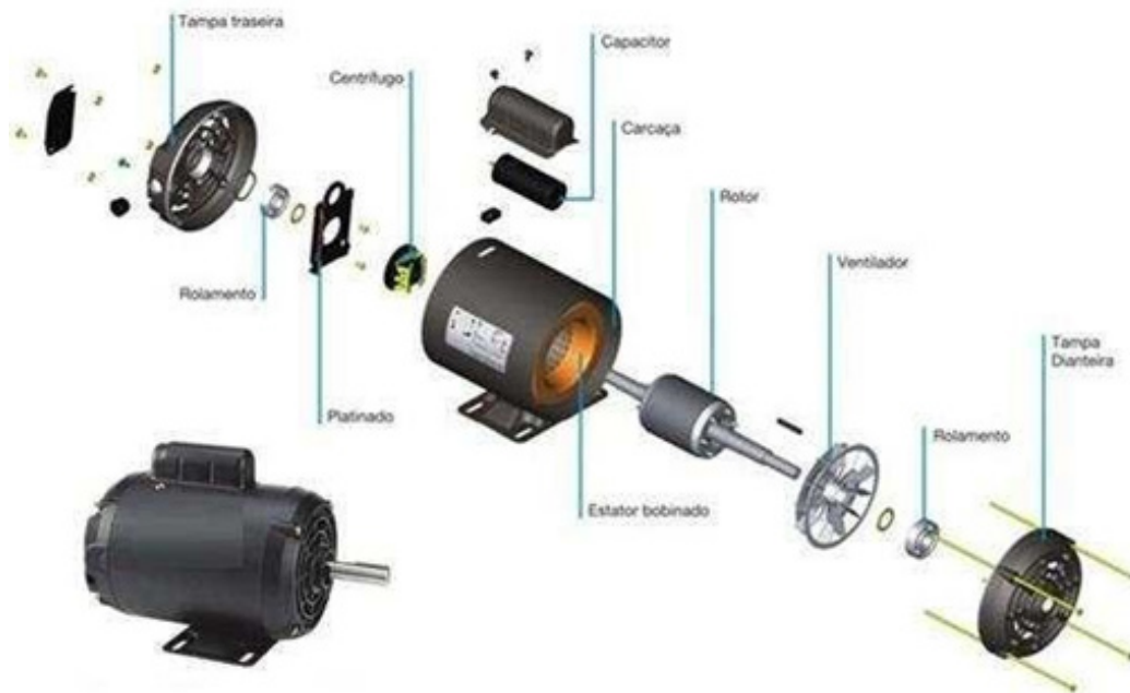
Vista explodida do Motor de Indução Monofásico
