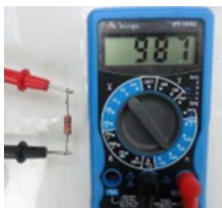
Teste com resistor na escala correta
