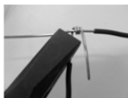
Iniciando a emenda tipo prolongamento
