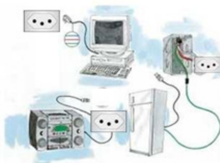
Uso obrigatório do condutor terra
