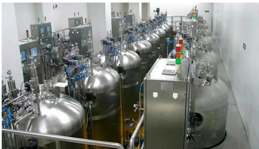
Figura 9: Automação de reatores químicos
