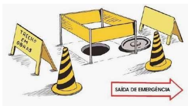
Figura 05: Equipamentos de Proteção Coletiva.
