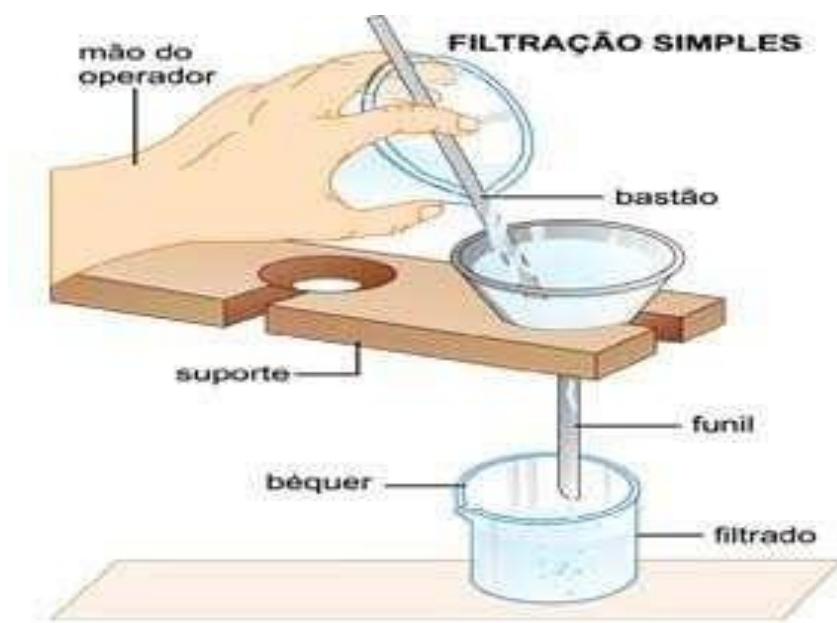
Figura 4: Separação por solução e filtração
