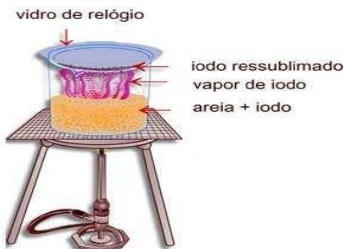
Figura 3: Separação por sublimação
